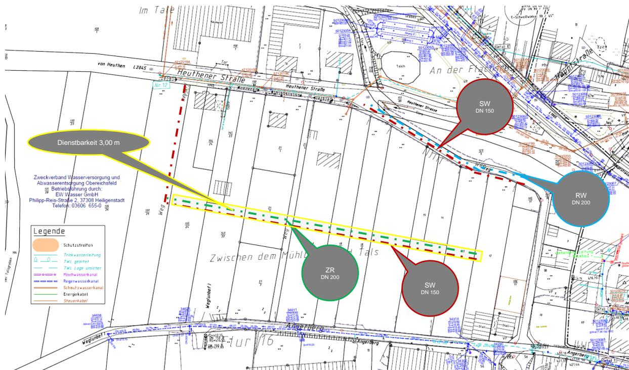
Lageplan zeigt das vorhandene Trennsystem, die möglichen Anschlusschächte für Schmutzwasser und den Verlauf der Ebra für die Anbindung des Oberflächenwassers.
