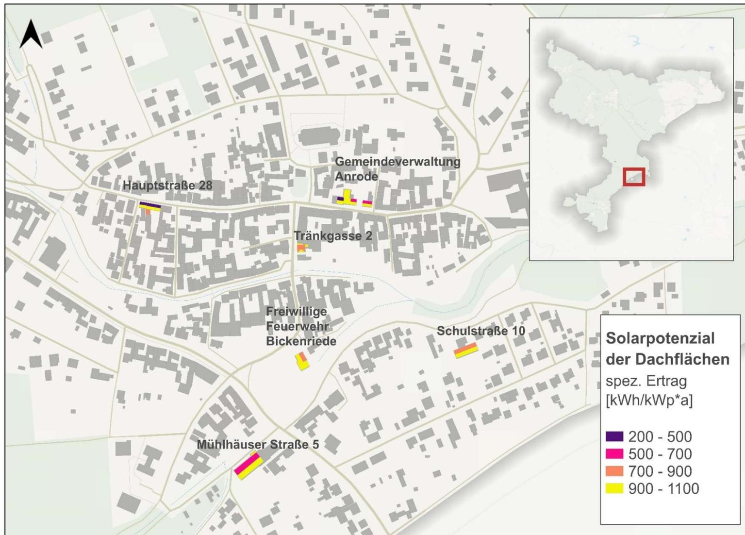
Abbildung 44 Solarpotenzial der kommunalen Dachflächen in Bickenriede
